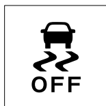
ESC OFF (išjungta) indikatoriaus lemputė
