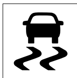
TCS OFF (išjungta) indikatoriaus lemputė
